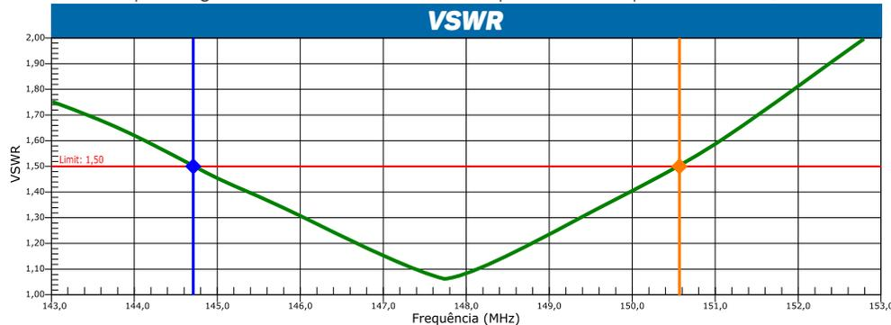
Gráfico obtido com antena instalada no centro de uma chapa metálica 1,4m x 1,1m.
