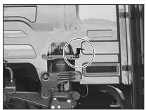
Posicione o suporte e aperte bem o parafuso para que não se solte e nem provoque danos ao veículo com a vibração do caminhão.
