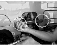
Solte e retire um dos parafusos como mostra a figura acima.
