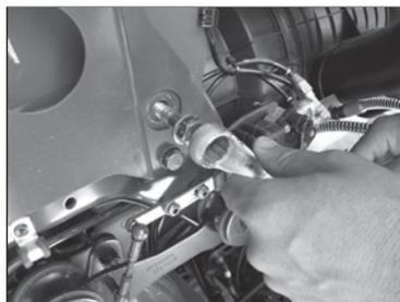
Segundo parafuso que será usado para a fixação do suporte. Parafusos já existentes no caminhão.
