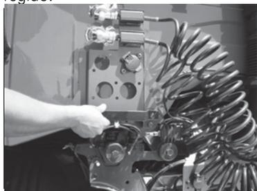
Posicione o suporte e coloque de volta os parafusos.
