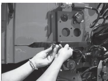
Fixe bem os parafusos para que não venham a se soltar com a vibração do caminhão.
