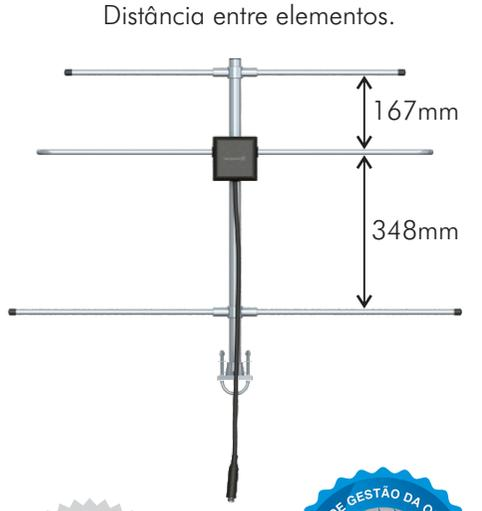
Para fixar os elementos no tubo central, basta alinhar o furo do parafuso com o escareado e, logo em seguida, inserir o parafuso no furo e apertar com uma chave allen de 3 mm (inclusa no kit de fixação)
