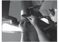
Região onde o suporte deverá ser Abra o capo, localize o parafuso que Encaixe o suporte na lataria do instalado do lado do carona ou do fica na lateral, próximo a coluna do veículo de maneira que possa receber o parafuso de fixação.
