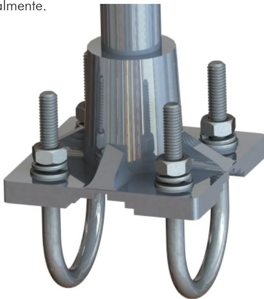
Las grapas de fijación son de acero inoxidable, incluyen una arandela plana, otra arandela elástica y una tuerca también de acero inoxidable, para una fijación perfecta del soporte en tubos de hasta 35 mm de diámetro exterior, lo que garantiza una mayor vida útil de todo el conjunto.
