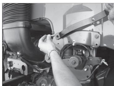
Posicione o suporte colocando o primeiro parafuso, porém não dê o aperto total até colocar o segundo parafuso.
