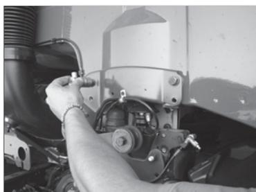
Solte um parafuso de cada vez, pois esses parafusos tem a função de fixar outros componentes do caminhão.
