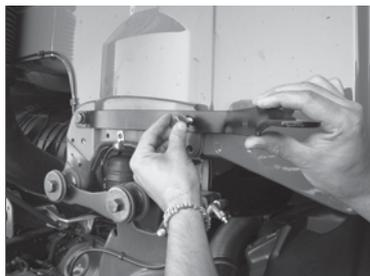
Já com os dois parafusos fixos deve-se dar o aperto final para que o suporte não venha a se soltar com a vibração do caminhão.
