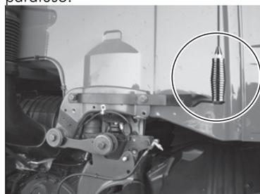
Assim o seu suporte STEELBRAS já está pronto para receber a Antena Móvel PX 1/4 de Onda.
