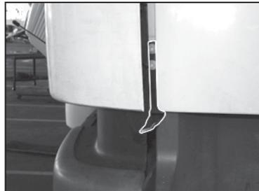
Aperte bem os parafusos para que o suporte não venha a se soltar com a vibração do caminhão.
