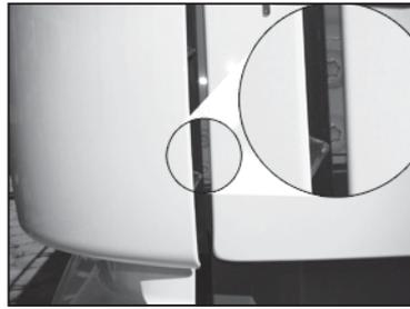
Atenção, o suporte será fixado por dois parafusos localizados no espaço entre a porta e a carenagem do caminhão.
