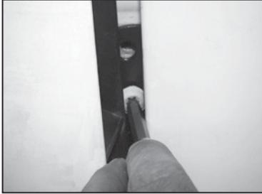
Posicione o suporte, encaixe e coloque de volta os dois parafusos.
