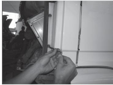
Abra o capô e solte os dois parafusos que ficam na lateral como mostra a figura acima.
