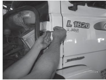
Posicione o suporte e coloque os parafusos.
