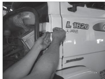
Posicione o suporte e coloque os parafusos.
