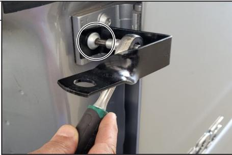
Fixe o suporte aproveitando o parafuso que fixa a dobradiça. Posicione o suporte e aperte bem o parafuso para que não solte e nem provoque danos ao veículo com vibração.
