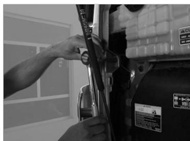
Abra o capô e solte os parafusos que ficam na lateral como mostra a figura acima.
