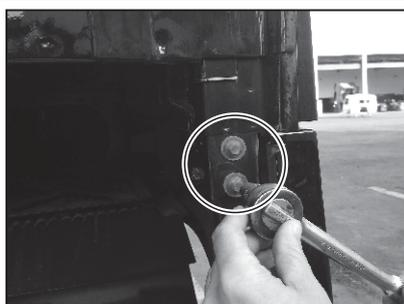
Solte e retire os parafusos como mostra a figura acima.
