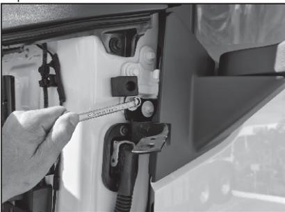
Posicione o suporte e aperte bem os parafusos para que não se soltem e nem provoquem danos ao veículo com vibração.
