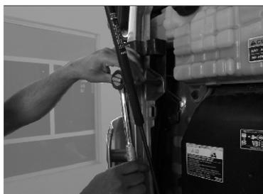
Posicione o suporte e coloque os parafusos.
