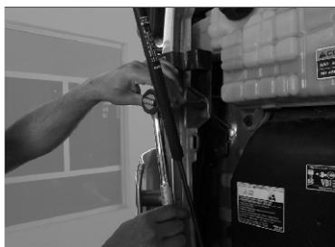
Posicione o suporte e coloque os parafusos.
