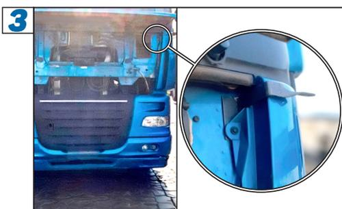
3 Fixaremos o suporte aproveitando apenas 1 parafuso que prende o defletor. O parafuso deve ser bem apertado para evitar que o suporte se solte devido à vibração do caminhão.
