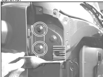
Posicione o suporte e aperte bem os parafusos para que não se solte e nem provoque danos ao veículo com a vibração do caminhão.
