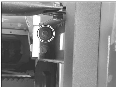
Solte e retire um dos parafusos como mostra a figura acima.
