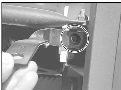
Posicione o suporte e aperte bem o parafuso para que não se solte e nem provoque danos ao veículo com a vibração do caminhão.
