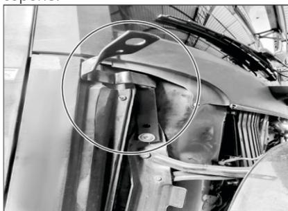
Posicione o suporte e aperte bem o parafuso para que não se solte e nem provoque danos ao veículo com vibração.
