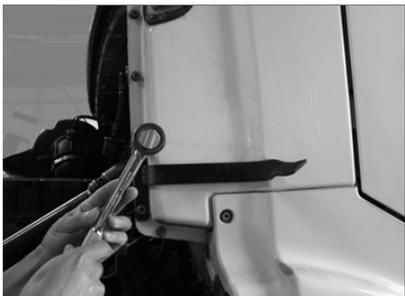
Posicione o suporte e aperte bem os parafusos para que não se soltem e nem provoque danos ao veículo com vibração.
