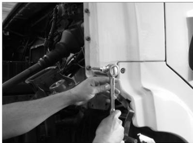
Abra o capô e solte os dois parafusos que ficam na lateral como mostra a fiatura acima.
