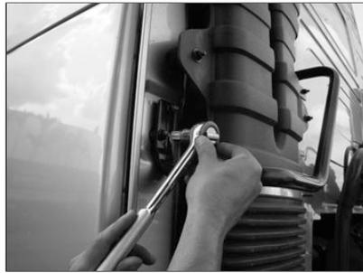
Solte os dois parafusos atrás da cabine do lado do motorista como mostra a figura
