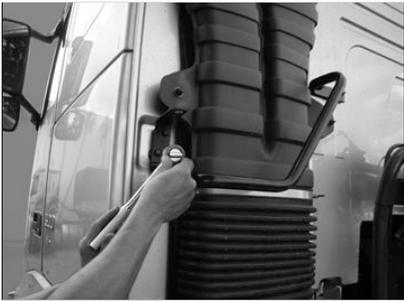
Posicione o suporte e aperte bem os parafusos, para que não se solte e nem provoque danos com a vibração do veículo.
