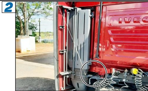
Solte e retire um dos parafusos como indicado na figura acima.
