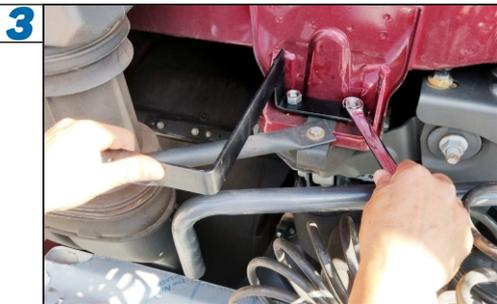
Posicione o suporte e aperte bem o parafuso utilizando as 2 porcas que acompanham o suporte, para que não se solte e nem provoque danos ao veículo com a vibração do caminhão.
