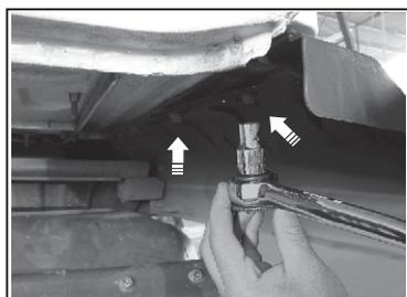
Solte os dois parafusos que ficam localizados na parte da baixo da cabine do caminhão.
