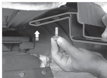
Posicione o suporte, encaixe e aperte parcialmente o primeiro parafuso.
