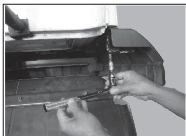
Com o auxílio de uma chave específica, realize o aperto final de ambos os parafusos, para que o suporte não solte com a vibração do caminhão
