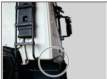
O suporte será fixado por baixo da cabine do caminhão IVECO, podendo ser instalado do lado do carona ou do lado do motorista.
