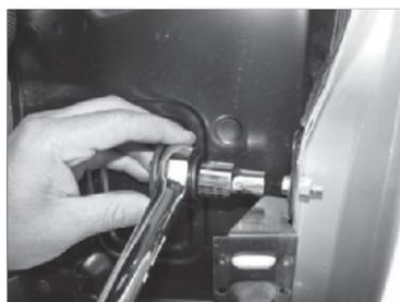
Solte os parafusos que fixam o batente da fechadura do capô como mostra a figura acima.
