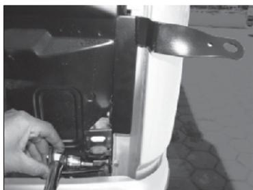
Aperte bem os parafusos que fixam o suporte para que não venha a se soltar com a vibração do caminhão.
