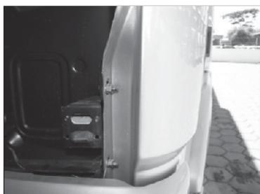
Abra o capô do caminhão e localize os dois parafusos que fixam o batente da fechadura do capô.
