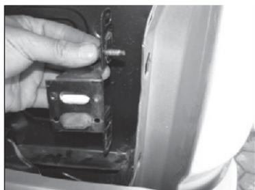
Serão usados os mesmos parafusos. **\*\*Obs.:** Marque bem a posição do batente da fechadura para não desalinhar o capô.
