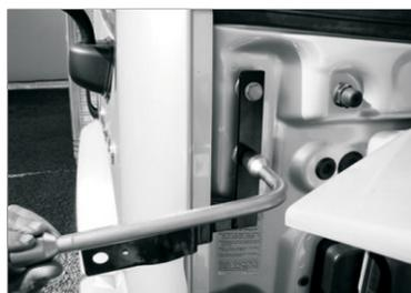
O próximo passo é apertar bem os dois parafusos para eliminar o risco de se soltar com a vibração do caminhão.
