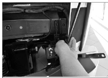
Ao abrir o capô solte o parafuso de fixação do suporte do amortecedor do capô. Cuidado pois o capô pode descer rapidamente.
