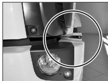
O suporte da antena será fixado pelo mesmo parafuso que sustenta o suporte do amortecedor como mostra a figura.
