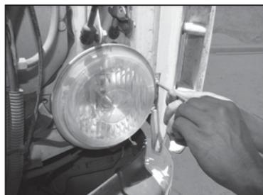
Deverá ser deslocado a carenagem lateral, para isso devemos remover a lanterna para ter acesso a um dos parafusos.
