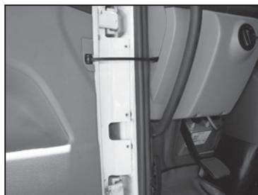
Devera também ser removido os parafusos da coluna que também auxiliam na fixação da carenagem.
