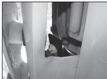
Posicione o suporte e aperte bem o parafuso para que não venha a se soltar com a vibração do caminhão.
