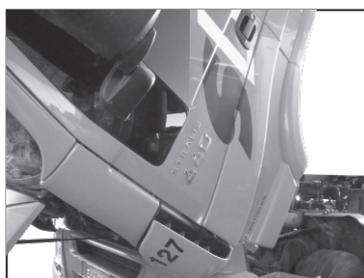
Para facilitar a fixação do suporte é importante bascular a cabine.
