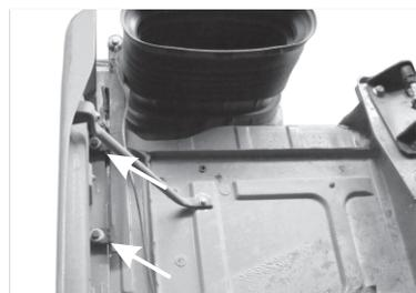
Parafusos que devem ser usados para a fixação do suporte.
