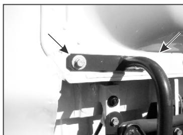
Parafusos que devem ser usados para a fixação do suporte, exceto lado do carona.
