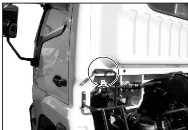
Aperte bem os parafusos para que não venham a se soltar com a vibração do caminhão.
