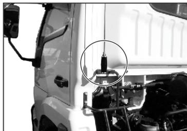
Seu suporte STEELBRAS já está pronto para receber a Antena Móvel PX 1/4 de Onda.
