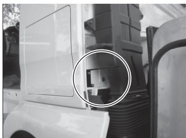
Posicione o suporte e aperte bem os parafusos para que o suporte não venha a se soltar com a vibração do caminhão.
