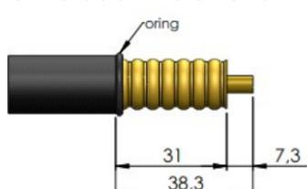
**Colocar o redutor até encostar no oring e dobrar a parte indicada no desenho até encostar no redutor.**
