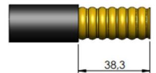
**Cortar cabo conforme figura e introduzir o anel oring.**
