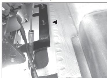
Coloque o segundo parafuso, aperte bem para que o suporte não venha a se soltar com a vibração do caminhão.
