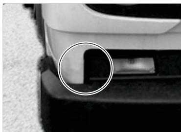
Ponto onde o suporte deverá ser instalado, lado do carona ou lado do motorista, (bascule a cabine para facilitar a fixação).
