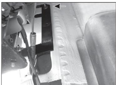
Coloque o primeiro parafuso com a porca, porém não aperte até que seja colocado o segundo parafuso.
