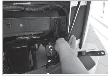
Ao abrir o capô solte o parafuso de fixação do suporte do amortecedor do capô. Cuidado pois o capô pode descer rapidamente.
