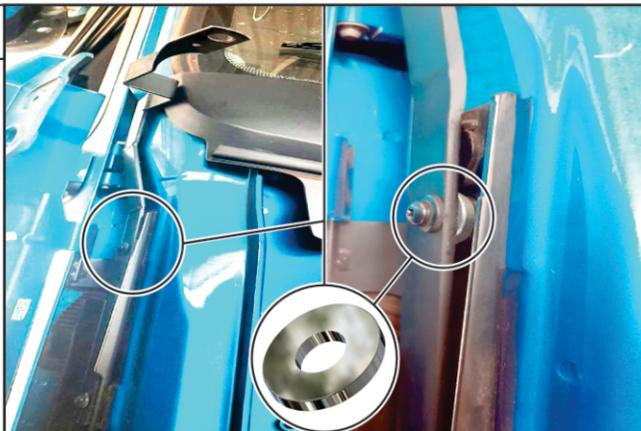
Fixe o suporte utilizando os parafusos do caminhão e a arruela de calço especificados na imagem acima. Posicione o suporte e aperte bem o parafuso para que não se solte e provoque vibração.
