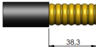
**Cortar cabo conforme figura e introduzir o anel oring**
