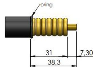
**Colocar o redutor até encostar no oring e dobrar a parte indicada no desenho até encostar no redutor.**
